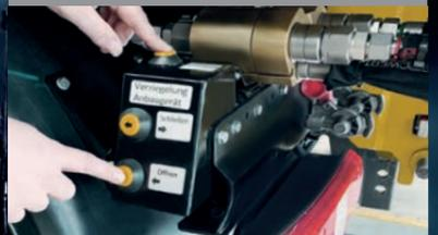
**+ Hydraulische Verriegelung.**
